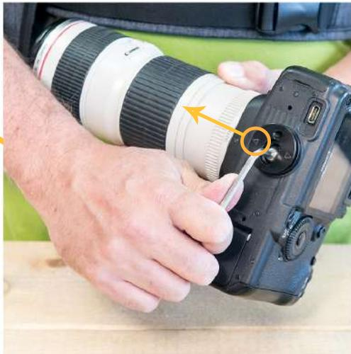
2. Glissez la rondelle de caoutchouc sous la platine ronde et vissez l'ensemble sous votre appareil photo, les flèches dans le sens de l'objectif.
